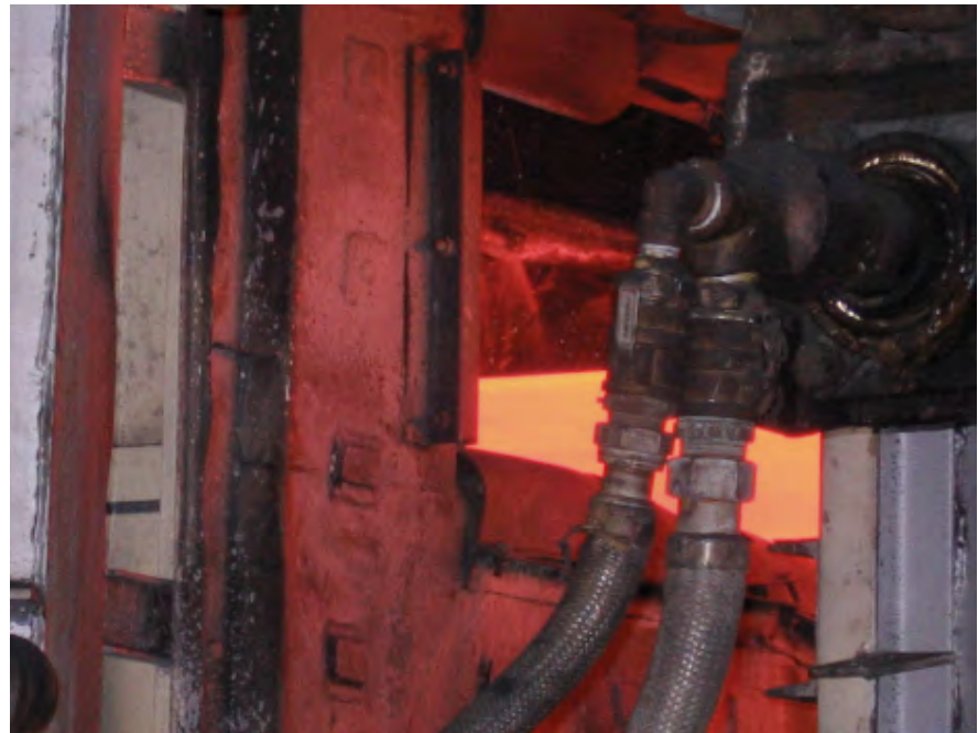
Figura 1. Material incandescente en el interior del horno de recocido.
