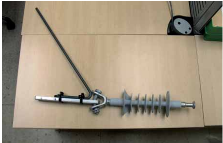
Figura 11. Armado de antena sobre alargadera.
