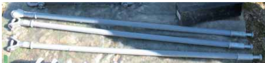
Figura 2. Bastón aislante de 36 kV.
