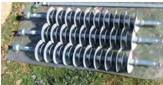
Figura 4. Aislador de composite de 66 kV.
