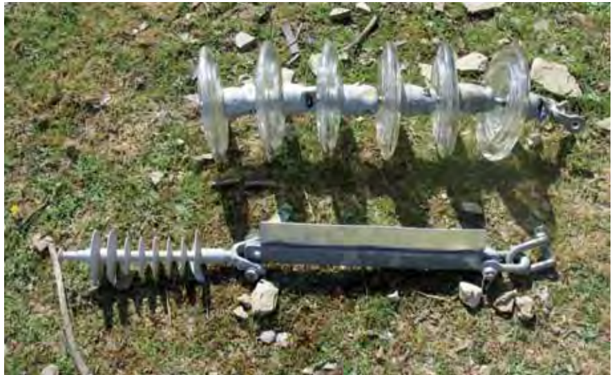
Figura 7. Aislador de composite más alargadera (en la parte inferior de la imagen).
