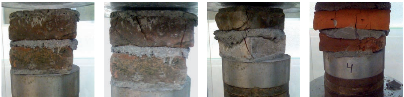
De izquierda a derecha: Maquinaria empleada para los ensayos de compresión de las muestras cerámicas (laboratorio EUAT, Universidad de Granada) y muestras cerámicas números 1, 2 y 3. Fuente: Elaboración propia.
