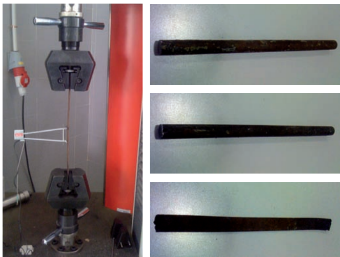
A la izquierda, maquinaria empleada para los ensayos de tracción de las muestras de acero (laboratorio ETSICCP, Universidad de Granada). A la derecha, de arriba abajo, muestras de acero números 1, 2 y 3. Fuente: elaboración propia.
