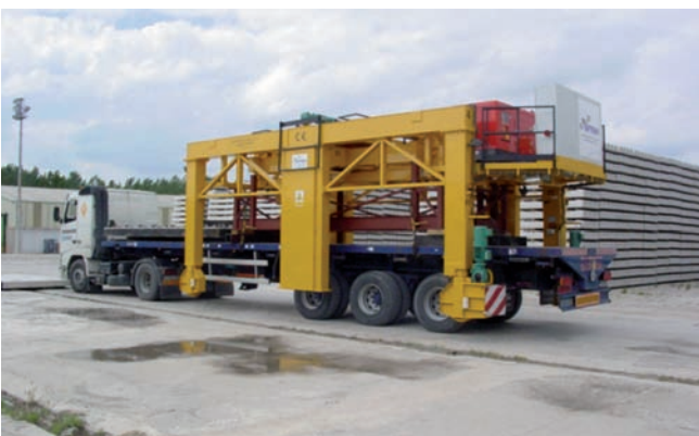
Figura 5. Transporte del pórtico nivelador.
