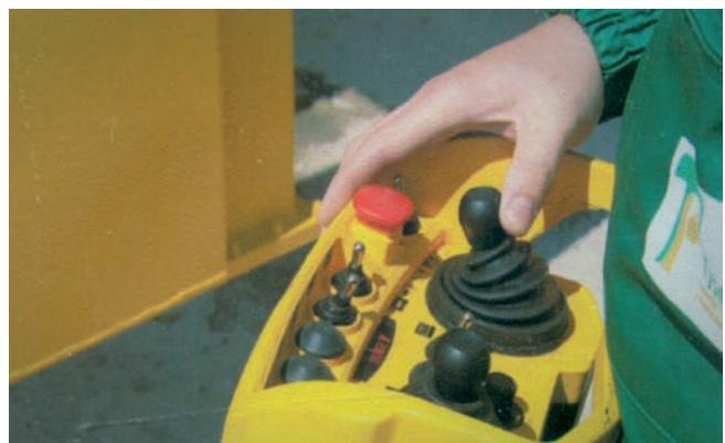
Figura 6. Equipo de radio frecuencia.
