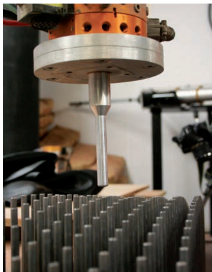
Robot desarrollado por los alumnos de la cátedra Cerámica de Harvard para crear las baldosas personalizadas.
