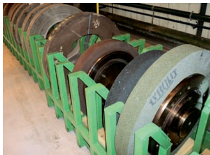
Figura 1. Ejemplo de componente: muelas para el rectificado de cilindros del tren de laminación. (Foto: gentileza de ArcelorMittal Sagunto.)
