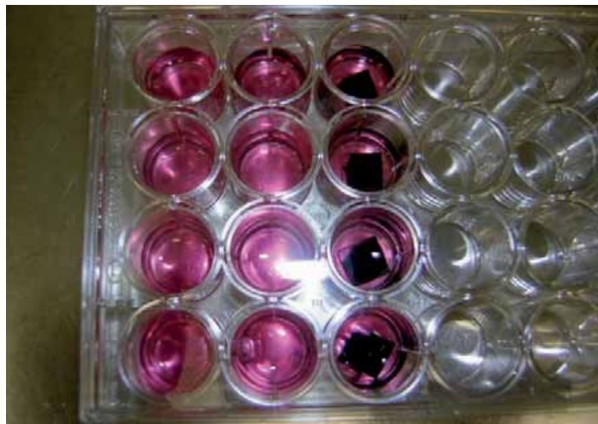
Figura 12. Compartimentos de cultivo de monocapas celulares sobre films polímeros conductores.
