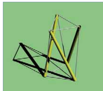
Figura 1. Rotación y traslación del triángulo superior con respecto al inferior en el simplex, debidas a la estabilización del mecanismo interno desarrollada por el estado de autotensión ( ss = m = 1 ).
