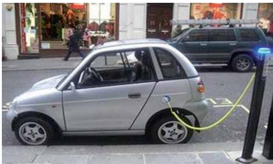
Figura 3. Conexión del coche eléctrico a la red.
