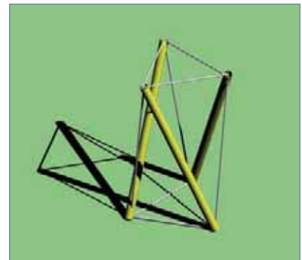
Figura 1. Rotación y traslación del triángulo superior con respecto al inferior en el símplex, debidas a la estabilización del mecanismo interno desarrollada por el estado de autotensión ( ss = m = 1 ).
