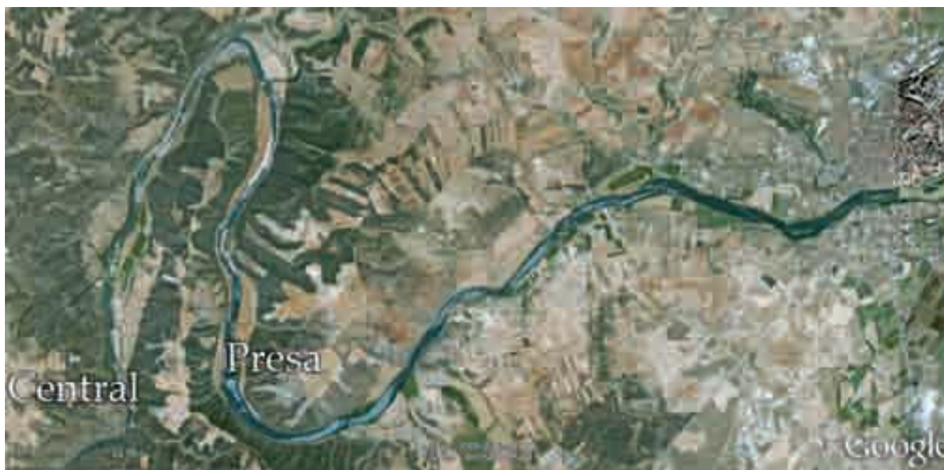
Figura 1. Planta hidroeléctrica de San Román de los Infantes. Un túnel horada la loma rodeada por el meandro del Duero para conducir el agua desde la presa a la central
