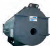
XV/AS Agua sobrecalentada. De 872 a 10.002 kW Tres pasos de humos - Presión 9,8 bar / 11,7 bar / 14,7 bar.
