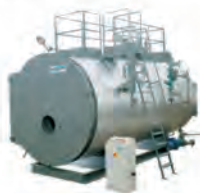
SB/V Caldera de vapor. De 2.000 a 10.000 kg/h Tres pasos de humo - Presión 11,8 bar / 14,7 bar.
