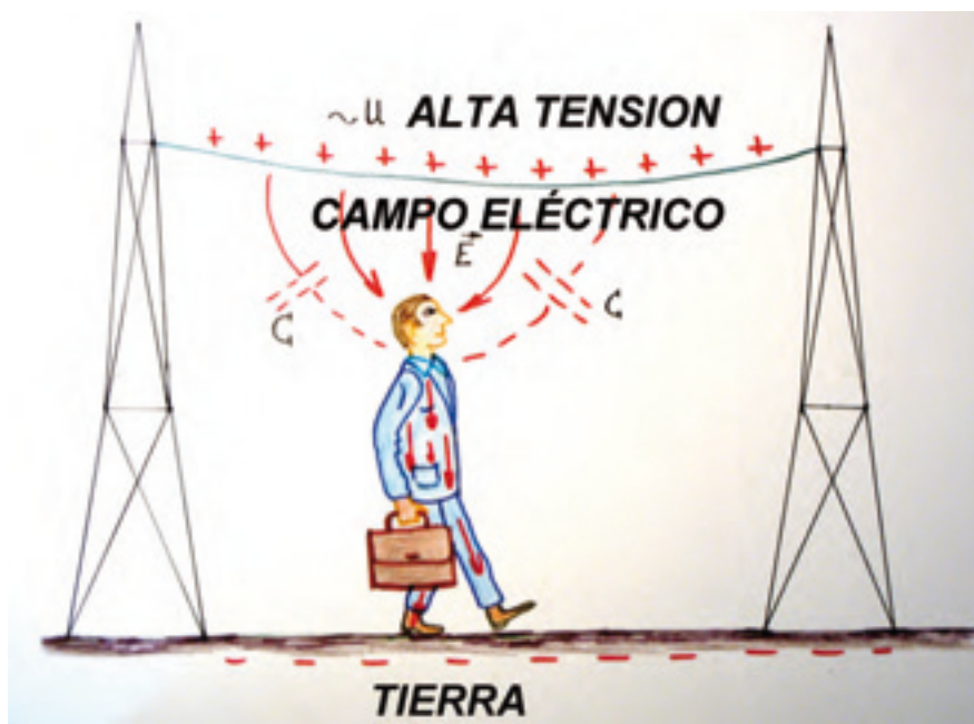
Figura 2. Campo eléctrico en las proximidades de líneas aéreas.
