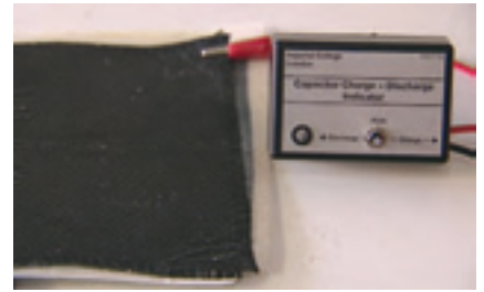
Medición de la capacidad de carga-descarga de un material experimental. / Imperial College London
