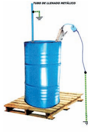
Figura 11. Llenado de bidón metálico sobre palet aislante.
