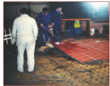
Figura 5. Aplicación práctica del sistema de conformado por líneas de calor en la construcción naval.
