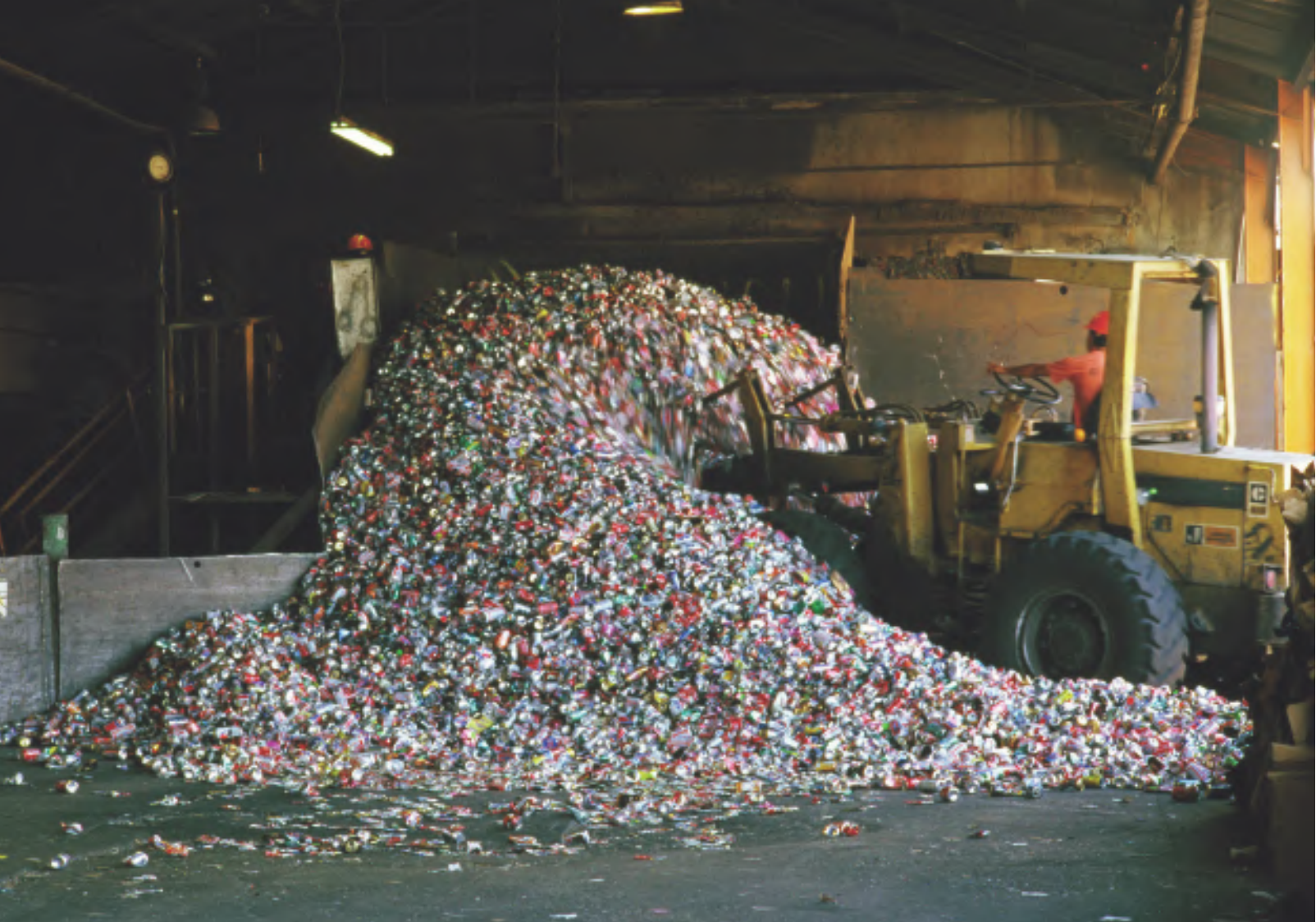
Almacén de residuos para el reciclaje de aluminio.
