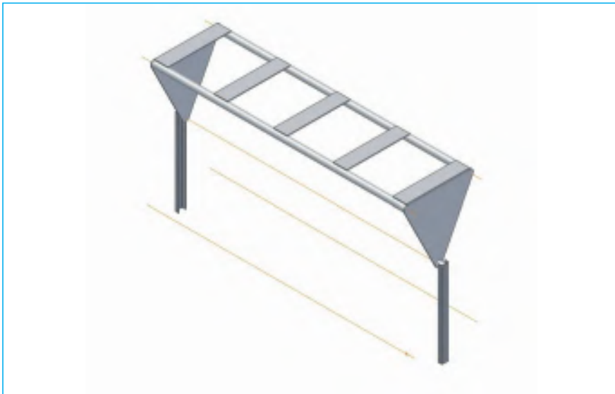
Figura 3. Plataforma en lugar más inestable girando a 180° y centro de gravedad más alto.
