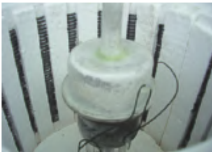
Figura 3. Reactor dentro del horno eléctrico sujetado con hilos de platino.
