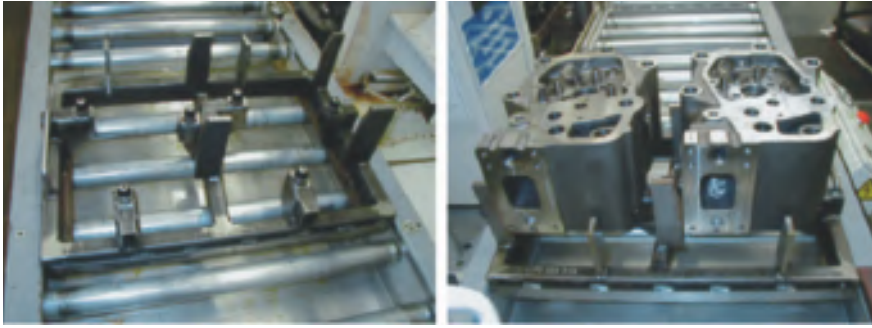
Figura 6. Poka Yoke: colocación de guías de posicionado.
