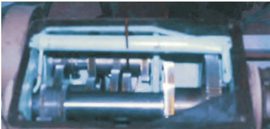
Foto 1. Lubricación de caja de avances en torno paralelo convencional.
