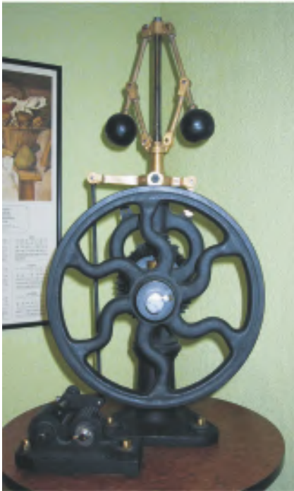
Foto 1. Limitador de bolas para controlar la velocidad de un ascensor. Podemos observar que este clásico limitador consta principalmente de una polea donde va introducido un cable que va unido al paracaídas, y de dos bolas de hierro colocadas en unas palancas. Estas bolas giran alrededor de un eje y, al aumentar la velocidad de giro, por la fuerza centrífuga, se abren y actúan sobre una palanca que aprisiona el cable y éste, al detenerse, dispara el paracaídas del chasis de cabina.
