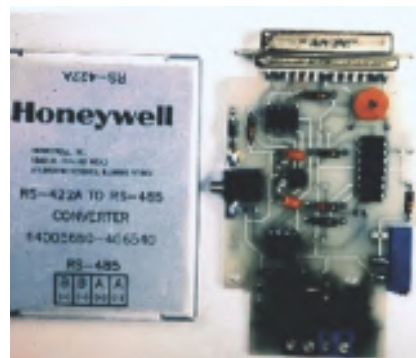
Figura 1. Daños por sobretensiones.
