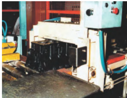
Figura 4. Paso de pieza a través del desmagnetizador.
