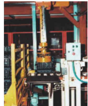
Figura 7. Traslado de pieza con pórtico electroimán a puesto de presentación.
