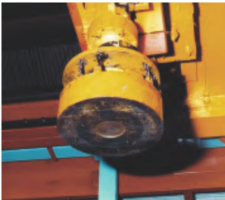
Figura 3. Electroimán suspendido del pórtico para toma de pieza.
