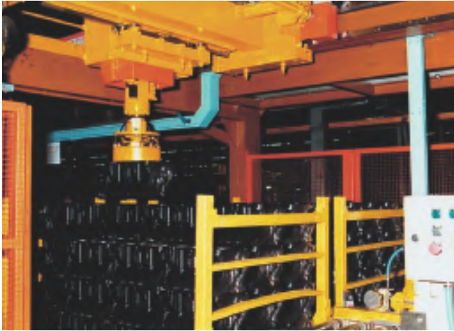
Figura 1. Presentación de piezas en contenedor y toma con electroimán.
