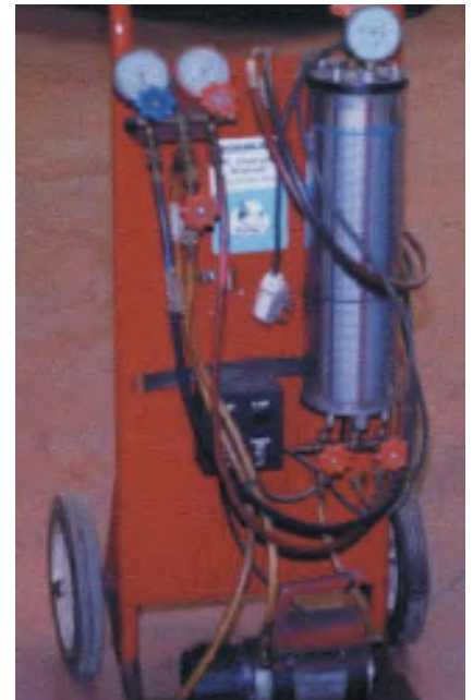
Figura 4. Estación automática de recuperación, reciclado y carga de refrigerante
