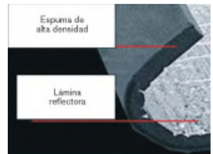
Figura 2. Panel aislante de espuma rígida de poliuretano
