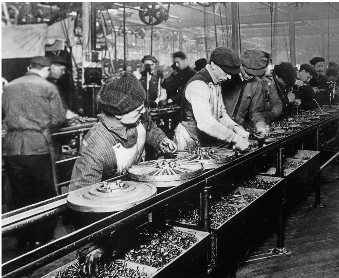
Los trabajadores de la primera línea de montaje móvil ensamblaban magnetos y volantes para los automóviles Ford de 1913. Highland Park, Michigan. Fuente: Autor desconocido. Dominio Público, via Wikimedia Commons.
