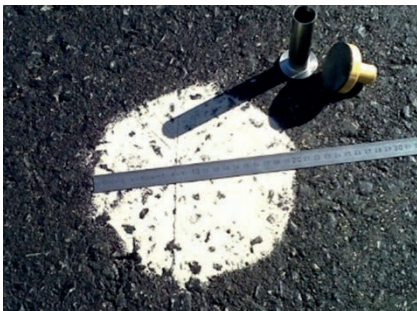
Figura 5. Ensayo de rugosidad en asfalto mediante técnica de parche volumétrico.
