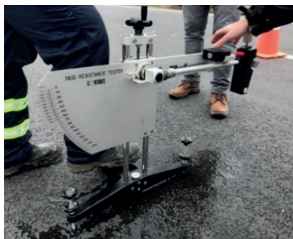
Figura 1. Ensayo de una superficie de asfalto mojado con péndulo británico.
