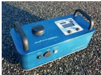
Figura 6. Ensayo de rugosidad en asfalto mediante dispositivo láser Dufournier.
