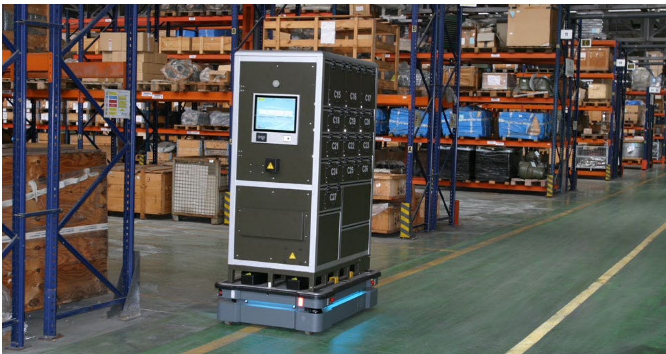
Sistema autónomo de transporte (Foto: PCMASA N° 1).
