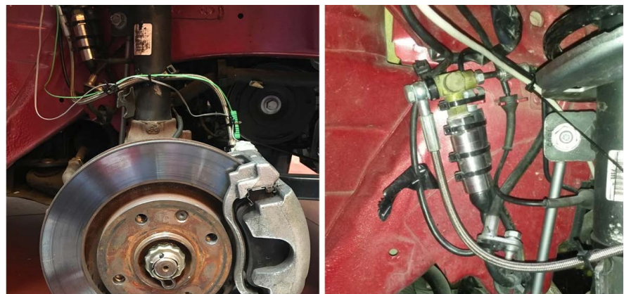
Figura 2. Ubicación del sensor de presión en el circuito hidráulico del lado derecho.
