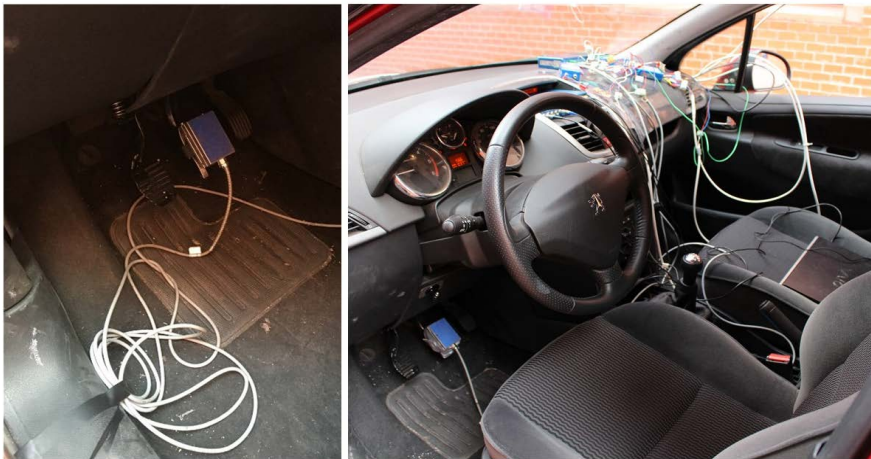
Figura 3. Ubicación de la célula de carga sobre el pedal de freno.
