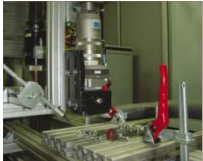
Figura 2. Imagen de la zona de trabajo con el cabezal del láser de Nd:Yag empleado en las pruebas.
