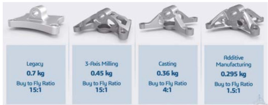
Figura 4. Comparación de resultados que obtener con diferentes procesos de fabricación (Dassault Systèmes, 2019).
