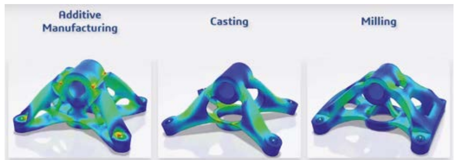
Figura 5. Simulaciones llevadas a cabo para comprobar la resistencia de las piezas (Dassault Systèmes, 2019).
