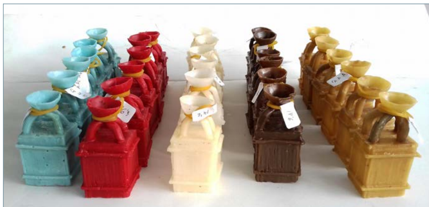
Figura 3. Muestras (CA) con cada una de las ceras. Azul de inyección: Az. Roja de modelar: R. Virgen de abeja: Ab. Blanca microcristalina: B. Marrón de estructura: M.
