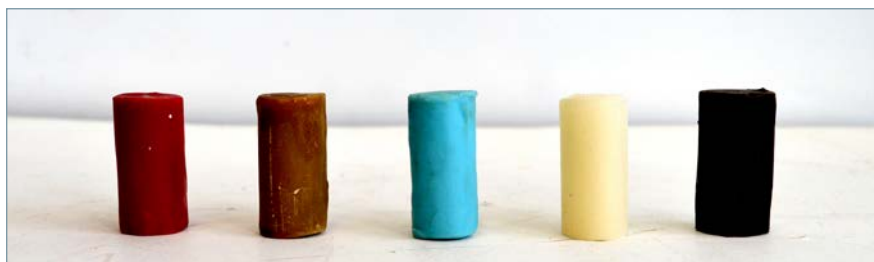
Figura 1. Modelos para las pruebas iniciales. De izquierda a derecha: roja de modelar, virgen de abeja, azul de inyección, microcristalina y marrón de estructura.
