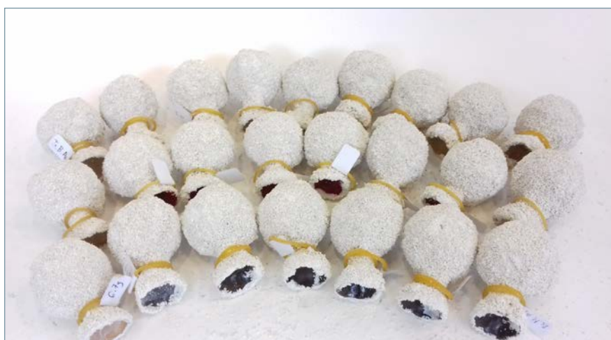
Figura 4. Moldes de cascarilla cerámica de la muestra ES.
