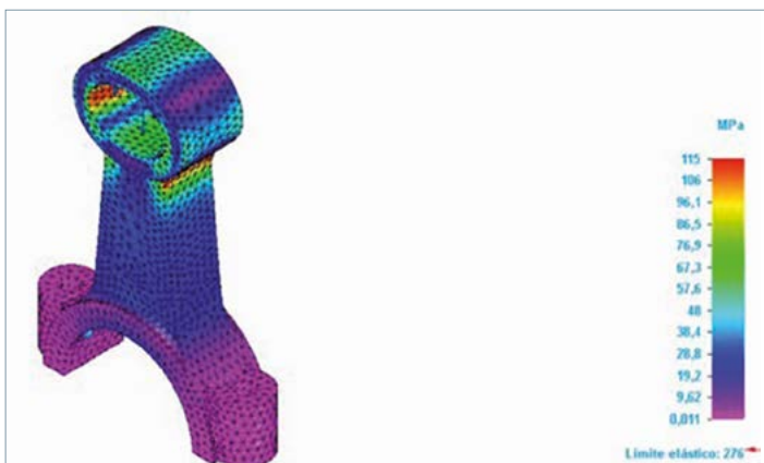
Figura 4. Tensión de Von Mises de pie de biela al aplicar 17419N de fuerza en Solid Edge ST10 (Al. 1060).
