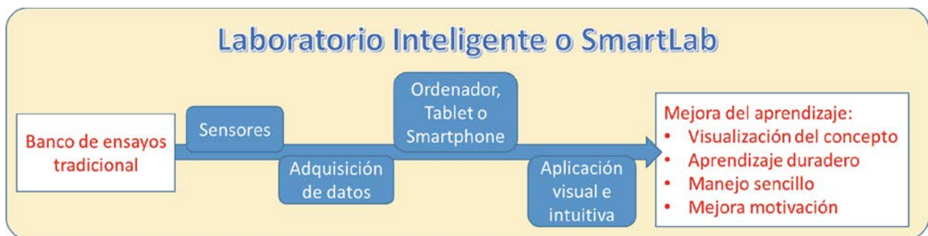
Figura 1. Transformación de un banco de ensayos tradicional en un laboratorio inteligente o SmartLab.
