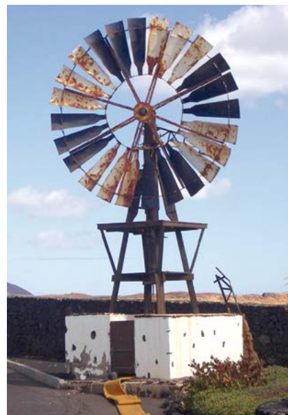
Figura 2. Aeromotor salinero de rotor de multipala metálica. Costa Teguiuse. Lanzarote. Fotografía: Víctor Manuel Cabrera García.
