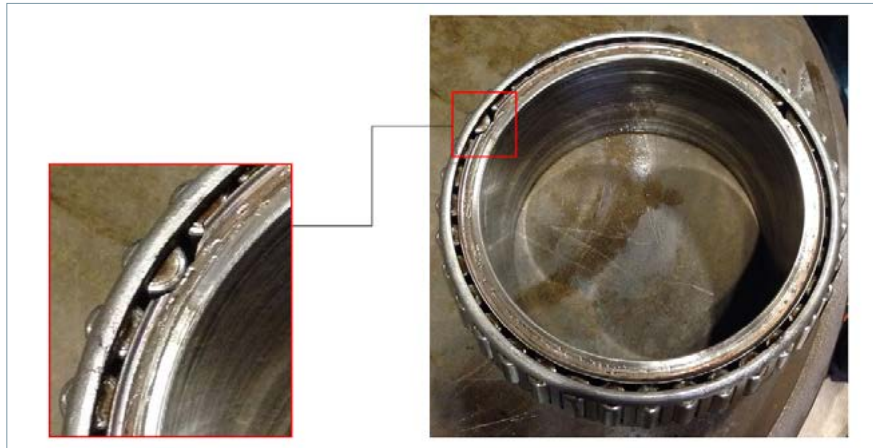
Figura 16. Profundo desgaste en el anillo interior del rodamiento. Picaduras profundas, grietas por calor y adhesión pronunciada.
