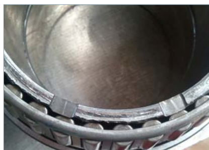
Figura 6. Desgaste en la cara del anillo interior del rodamiento.
