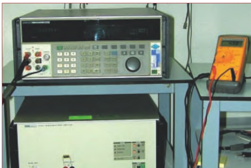
Figura 5. Montaje para calibrar en corriente un multímetro.
