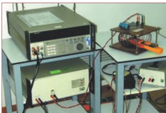
Figura 13. Bobina toroidal con compensación capacitiva.
