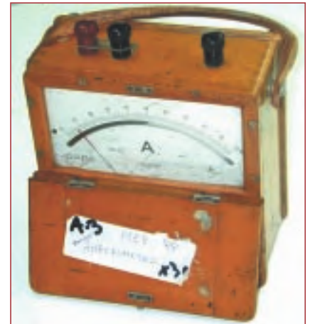
Figura 9. Amperímetro de la casa Mathias.
