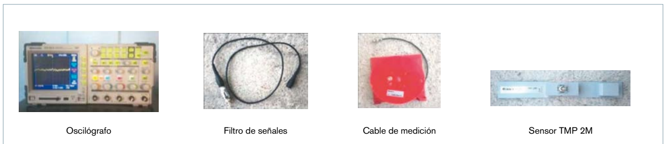
Figura 4. Equipos de medición para obtener los oscilogramas y localizar los defectos.
