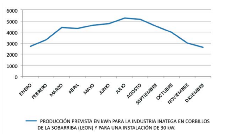
Figura 7. Producción de electricidad FV para una potencia nominal de 30 kW ( http://www.onyxosolar.com ).
