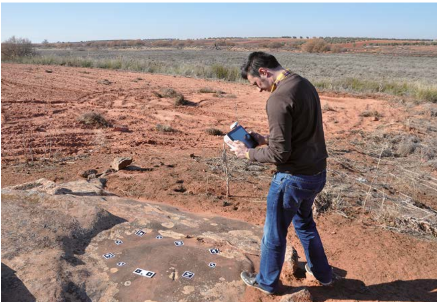
Los nuevos sistemas de digitalización como EyesMap permiten documentar yacimientos arqueológicos a gran velocidad con una precisión inédita hasta la fecha. Foto: Víctor Manuel López-Menchero / Sociedad Española de Arqueología Virtual (SEAV).
