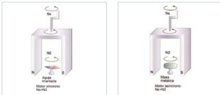
Figura 7. Esquemas de los motores síncrono y asíncrono.
