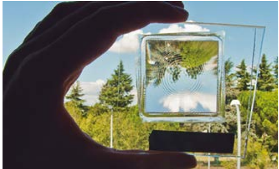
Arriba, prototipo de lente acromática desarrollada por el IES-UPM en el proyecto CPVMatch. Abajo, lente de Fresnel clásica y lente nueva que permite triplicar la concentración alcanzable. Foto e ilustración: UPM.
