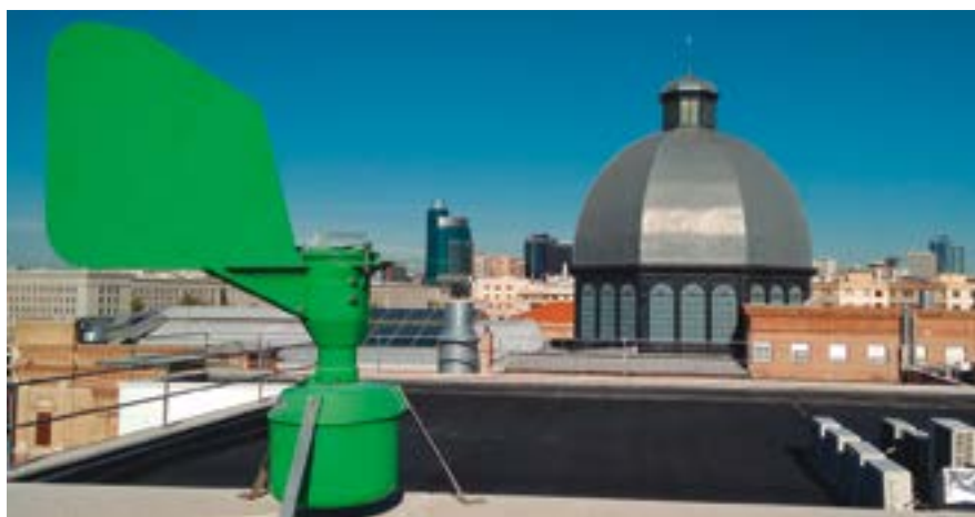
Captador de la microbiota del aire situado en la terraza de la ETSII de la UPM. Foto: UPM.
