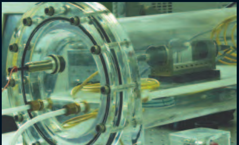
Celda sensora de fibra óptica dentro de un tubo de laboratorio para medir metano, desarrollado por el Grupo de Ingeniería Fotónica de la Universidad de Cantabria
