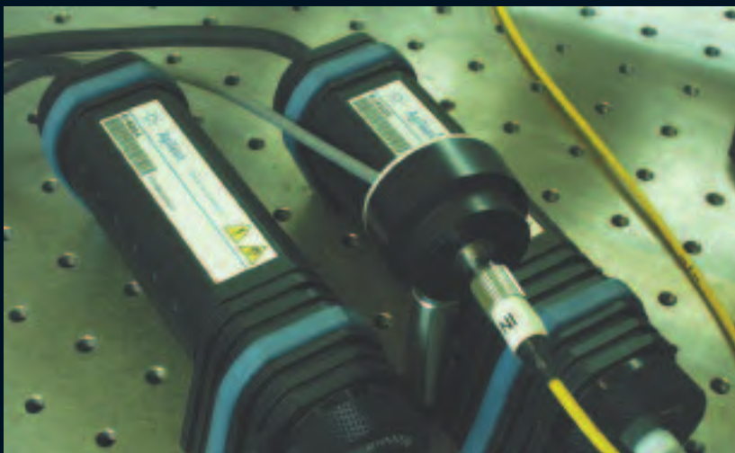
Juego de tres cabezas fotodetectoras optoelectrónicas (G.I.F. de la UC)
