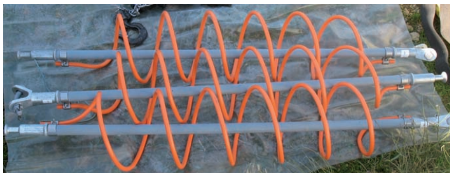
Figura 3. Bastón aislante de 36 kV de composite con espiral salvapájaros.
