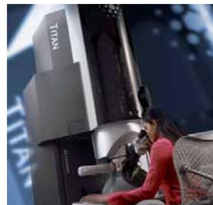
óptica electrónica de muy alta calidad, tensión de aceleración muy estable y detectores de imagen muy sensible. Estas cualidades son únicas del microscopio y permiten seguir los procesos de transformación en la muestra investigada, por ejemplo, cuando cambia su temperatura.
