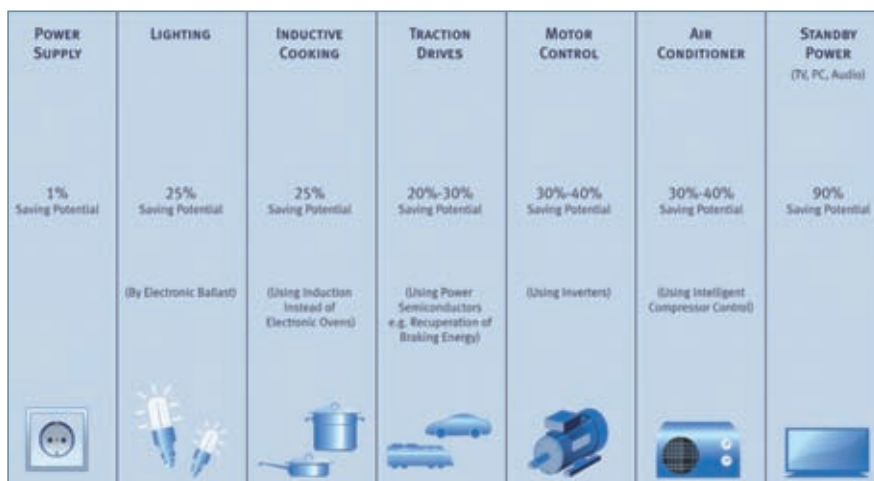
Figura 6. Capacidad de ahorro energético mediante técnicas de la electrónica de potencia.
