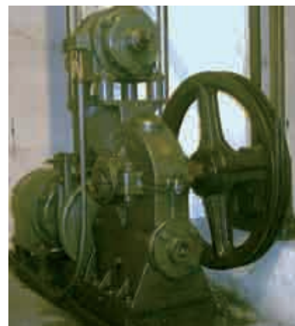
Figura 1. Máquina tractora sinfin-corona movida por un motor asíncrono.
