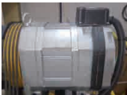
Figura 3. Máquina gearless con sincronía de imanes permanentes de la marca CEG.
