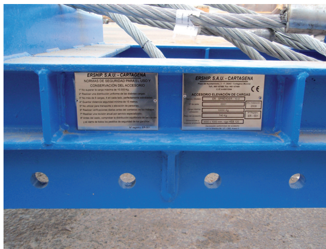
Figura 3. Vista de las chapas identificativas del accesorio de elevación.
