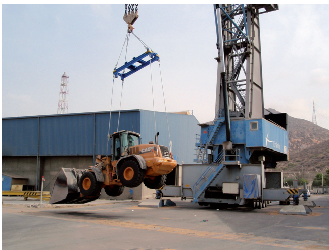
Figura 2. Vista de la prueba estática del spreader 10 toneladas, realizada con una carga (pala cargadora de 15.000 kg).
