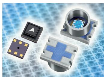
vada humedad. Los sensores de presión SMD T5000 y ASB1200E, que han sido optimizados para poder medir una presión absoluta de 300 a 1200 mbar y cubrir un rango de 20 mV / V / bar, cuentan con un chip MEMS piezoresistivo fabricado por Aktiv Sensor, filial de EPCOS, que actúa como núcleo de cada dispositivo.
