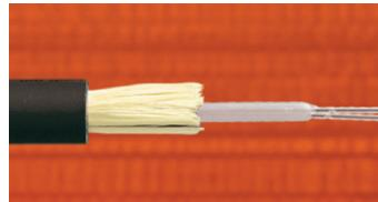
Estos cables compactos (3,5 mm de diámetro) y robustos son totalmente dieléctricos y se distinguen por un bajo coeficiente de fricción para convertirse en los modelos ideales para instalaciones bajo ducto por el sistema "blowair" (soplado).
