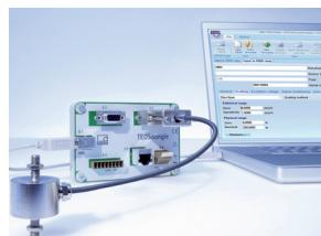
La compañía amplía así la compatibilidad de la tecnología TEDS (hoja electrónica de características del transductor) con la cual se reconocen y configuran automáticamente y de forma segura las cadenas de medición.
